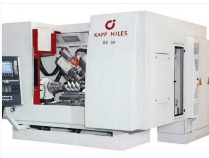
蜗杆砂轮磨齿机的砂轮：应修整成渐开线蜗杆，也就是使用模数、压力角与被磨齿轮相同的金刚滚轮（假想齿条）每移动一个齿距，蜗杆砂轮转动一圈。蜗杆砂轮磨齿机的砂轮修整器由修整电机和修整机构组成，修
