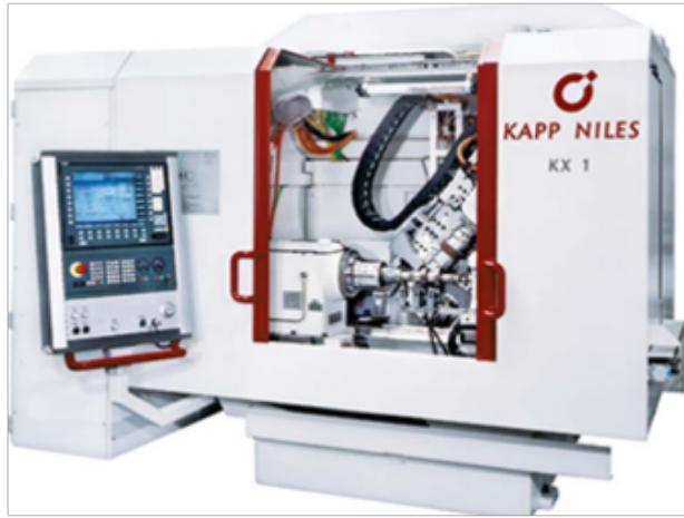
数控蜗杆砂轮磨齿机修整器与刀架碰撞问题的处理：数控蜗杆砂轮磨齿机在客户使用中经常发生修整器与主轴之间的碰撞，导致机床加工精度丧失，需要反复对各轴进行精度校验。通过分析用户加工程序与PLC之间通讯信号的处理，NCK数字输入信号IN的逻辑判断，找出了问题的根源在于PLC逻辑判断以及加工程序中接口信号应用不当，导致了该设备安全保护处理不到位。经过修改，问题得到了根本性的解决，提高了设备的可靠性。因为配对的齿轮中，小轮负担较重，因此为使大小齿轮工作寿命大致相等。
